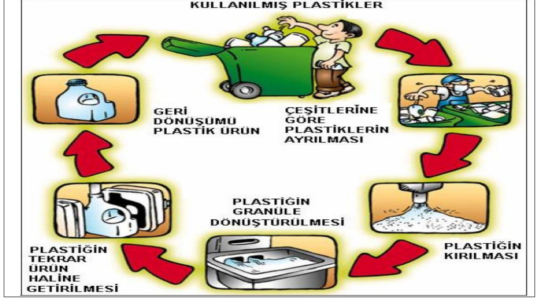
Şekil 2. 3. Plastik Geri Dönüşüm Akış Şeması
